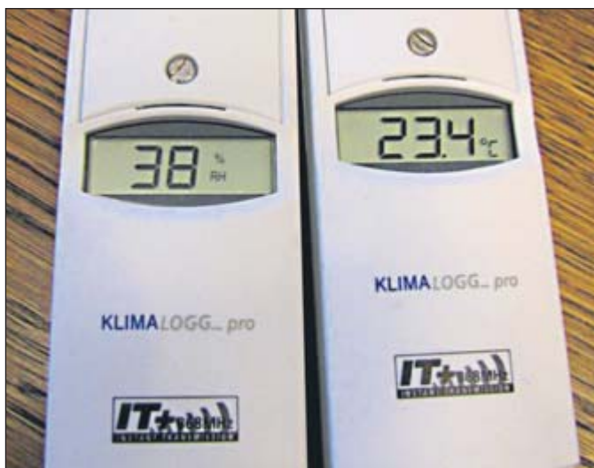
Mit Hilfe von Datenloggern dokumentierte der Energieausschuss Temperaturverläufe und Feuchtigkeitsgehalte.
